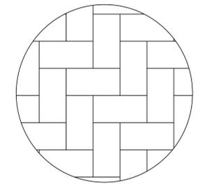
01 DETALHE DA INSTALAÇÃO DO PISO INTERTRAVADO (PAVER 6MM)
